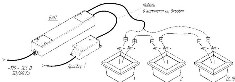
Рис.4 Монтажная схема подключения с блоком аварийного питания.
