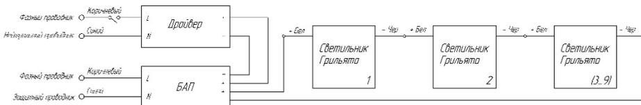
Рис.5 Принципиальная схема подключения с блоком аварийного питания.
