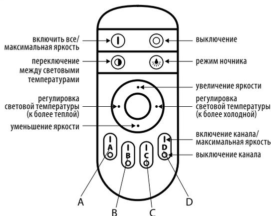
**Важно!** Пульт может управлять неограниченным количеством светильников, но на одном пульте каждый светильник может управляться только одним каналом. Программировать работу светильника можно не более, чем с 8 пультов.
