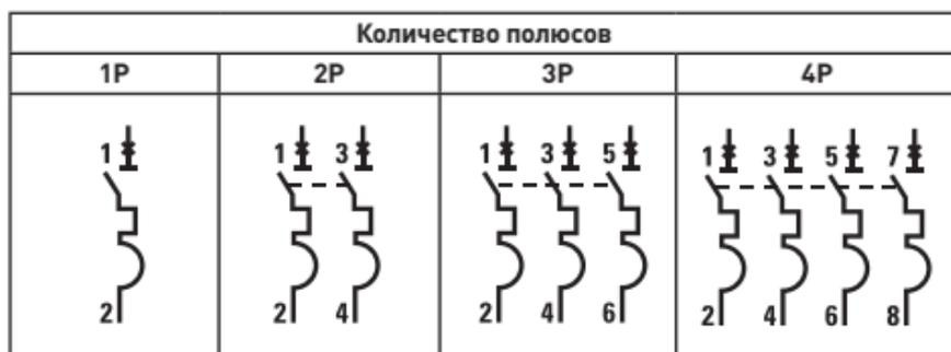
Рис. 4 - Схемы подключения
