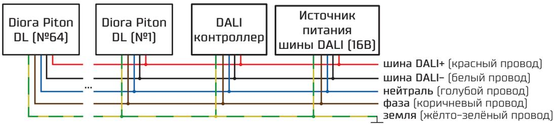
Источник питания шины DALI обеспечивает постоянное напряжение 16В и ограничивает ток на уровне 250 мА. На одной шине DALI должен быть установлен один источник. Рабочее напряжение шины лежит в диапазоне 9,5–22,5 В.
