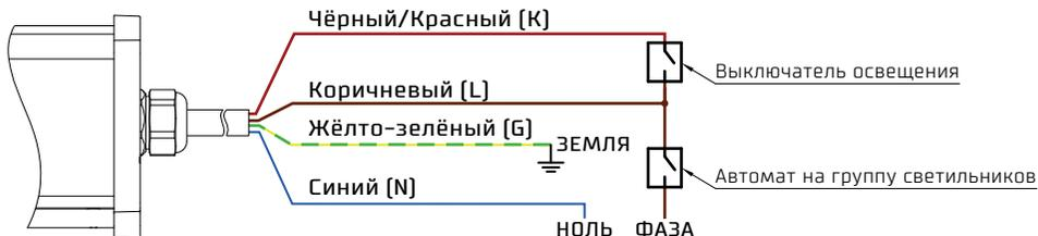
**Режим ожидания:** если на клемме «К» (выключатель) нет напряжения, а на аварийной клемме «L» есть напряжение, то светильник не работает, аккумулятор не заряжается.
