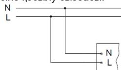
2. Шамдалдың резервтік қуаттандыру блогы бар қуаттандыру желісіне қосылу сыйбасы (суретте a - шамдал, b - резервтік қуаттандыру блогы).
