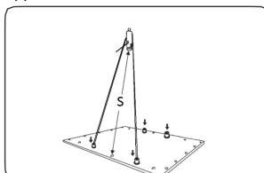
5.6. Прикрутити кабель підвісу до стельового фіксатора.
