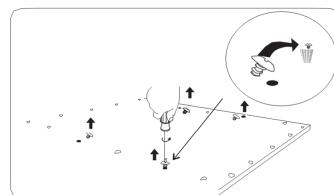
5.3. Пригвинтити кріплення підвісу до панелі світлодіодів.
