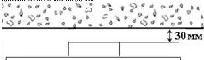
4. Не накрывать светильник теплоизолирующим материалом.
