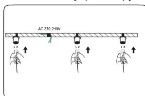
5.7. Рекомендуемое расстояние для крепления на потолке – 520 мм.
