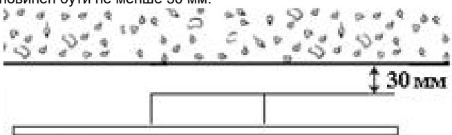
4. Не накривати світильник теплоізоляційним матеріалом.
