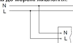
2. Схема підключення світильника до мережі живлення з блоком резервного живлення: (на мал. а - світильник, б - блок резервного живлення).
