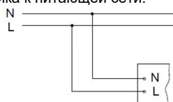
2. Схема подключения светильника к питающей сети с блоком резервного питания (на рис. а - светильник, б - блок резервного питания).
