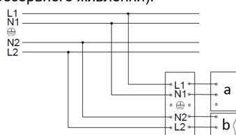
3. Схема підключення світильника до мережі живлення з регульованим драйвером по системі DALI .
