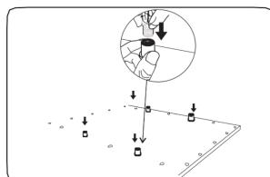
5.5. Відрегулювати довжину кабелю підвісу до потрібної довжини (де  $S$  - відстань). Для світильника розміром 595x595 відстань - 350 мм.
