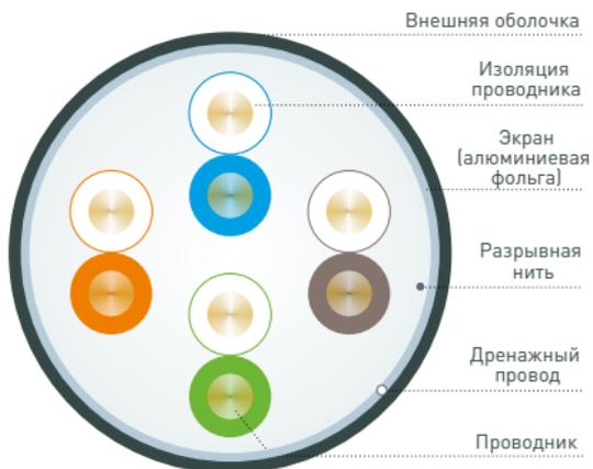
Рис. 3 – Конструкция кабеля F/UTP (количество жил 4x2)
