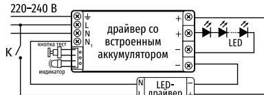
Схема подключения БАП в светильнике ДВО-01-A
