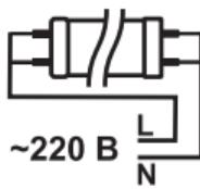
**Внимание!** Данная лампа предназначена для работы от сети ~220В без использования дополнительной пускорегулирующей аппаратуры.
