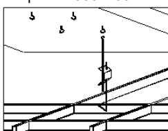
5.2. Снять рассеиватель светильника. В ячейку потолка установить световой прибор и закрепить элементами подвеса в отверстиях крепления. Установить рассеиватель.
