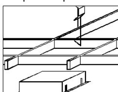
5.3. Отрегулировать длину подвесов так, чтобы плоскость светильника совпадала с плоскостью подвесного потолка. Собрать потолок.
