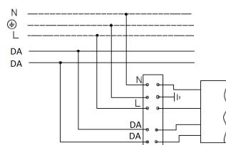
3. Схема подключения светильника к питающей сети с блоком резервного питания (на рис. а - блок резервного питания).
