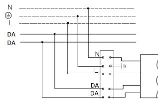
3. Резервтік қуаттандыру блогы бар қуаттандыру желісіне қосу сұлбасы : (сур. а - Резервтік қуаттандыру блогы).
