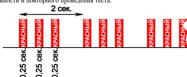
5.2.12. Если неисправностей во время теста длительности не выявлено, то ввод в эксплуатацию считается успешно выполненным. После чего на 24 часа автоматически включается заряд аккумуляторной батареи, а также автоматически запустится отсчёт времени для проведения последующих автоматических тестов: ежедневный функциональный тест, ежеквартальный тест длительности, согласно п. 6.
