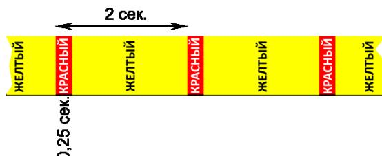
6.14. Если по окончании заряда напряжение на аккумуляторной батарее остаётся ниже 1В на элемент, то признаётся, что батарея неисправна. Зарядное устройство сохраняет пониженный ток заряда. Светодиодный индикатор светового прибора горит зелёным, но периодически через 2 секунды мигает красным секунды на 0,25 секунды, показывая низкое напряжение батареи. Если световой прибор подключен к ЩАО BS-ACTEON-2, то групповой индикатор «АО НОРМА» в ЩАО BS-ACTEON-2 гаснет до устранения неисправности.
