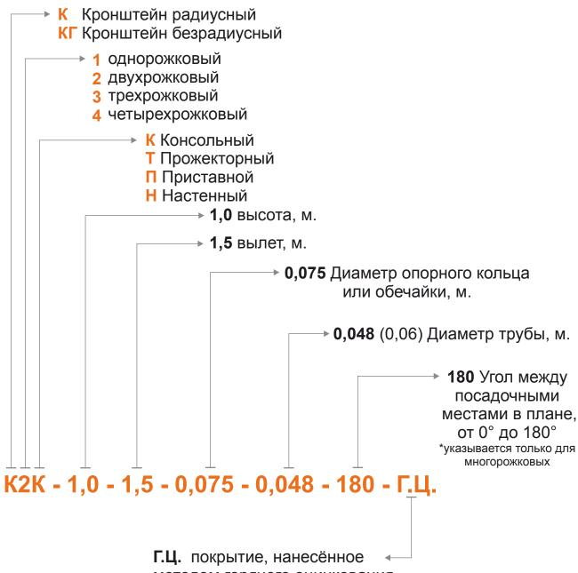
**Г.Ц.** покрытие, нанесённое методом горячего оцинкования **П.О.** покрытие, нанесённое методом порошковой окраски
