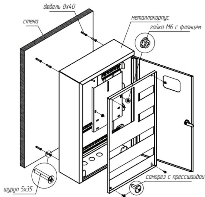
Рис. 1 - Схема монтажа
