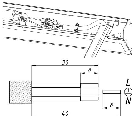
7. Повернути декоративну кришку на місце, закрутивши 6 гвинтів, і подсоедінть клему заземлення до декоративної кришки.
