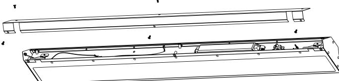
5. Підвісити світильник на кронштейни використовуючи комплект монтажний.
