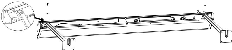
6. Зачистити мережевий кабель згідно з малюнком і підключити його до світильника. Кабель зафіксувати за допомогою кабельного затиску. При необхідності надлишки проводу підрізати.
