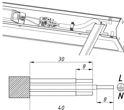
7. Вернуть декоративную крышку на место, закрутив 6 винтов, и подсоединить клемму заземления к декоративной крышке.
