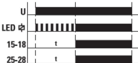
Задержка включения. После подачи питания начинается отсчет времени ( $T$ ) в это время контакты реле находятся в положении 15-16 (25-26) замкнут, а 15-18 (25-28) разомкнут (реле выключено). По окончании отсчета времени контакты 15-16 (25-26) размыкаются, а контакты 15-18 (25-28) замыкаются (реле включено) и продолжают находиться в таком положении до отключения питания.
