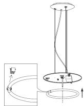
6. Установить рассеиватель на монтажную плату. Зафиксировать при помощи декоративной рамки.
