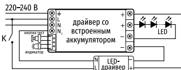
Схема подключения БАП в светильнике ДВО-13-А
