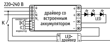
Схема подключения БАП в светильнике ДВО-12-А
