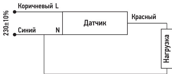
Рисунок 3. Схема подключения датчиков ДД 20ВБ
