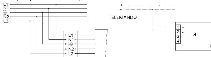
3. Схема підключення світильника до мережі живлення з регульованим драйвером по системі DALI .
