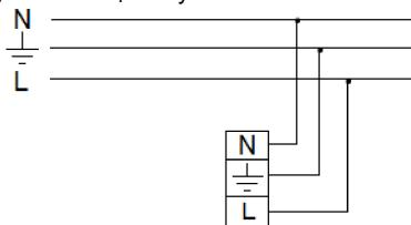
2. Резервтік қуаттандыру блогы бар қуаттандыру желісіне қосу сымбасы : (сур. а - Резервтік қуаттандыру блогы).
