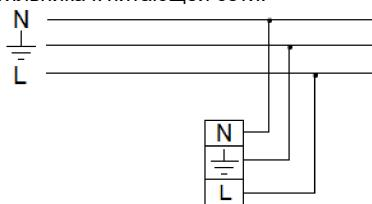
2. Схема подключения светильника к питающей сети с блоком резервного питания (на рис. а - блок резервного питания).
