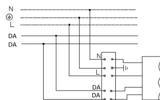
4. Схема подключения светильника к питающей сети с регулированием по системе 1-10V.
