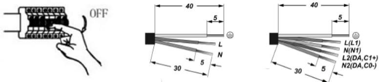
3. Подключить сетевые провода к колодке на задней стенке корпуса в соответствии с указанной полярностью. При использовании регулируемого драйвера, управляющие провода подключаются строго с соблюдением полярности, указанной в маркировке.
