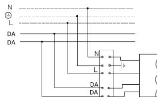
4. Шамшырақты 1-10V системасы арқылы реттеулі қуат беруші сымға жалғау схемасы.
