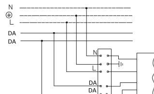
4. Схема поключення світильника до мережі живлення з регулюванням по системі 1-10V.
