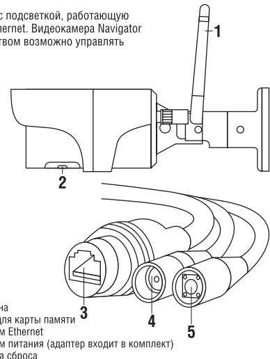
Также возможно подключение с использованием провода Ethernet (не входит в комплект, приобретается отдельно).
