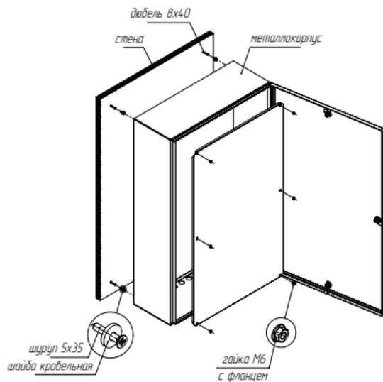
Рис. 1.1 - Схема настенного монтажа
