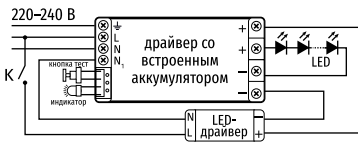
Схема подключения БАП в светильнике ДВО-04-А
