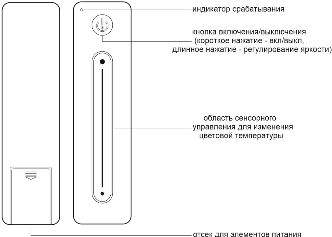
**Рис. 1 устройство пульта управления и назначение кнопок**
