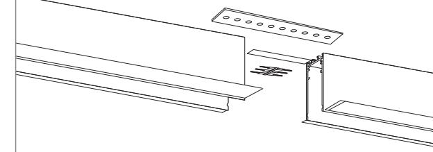
**!** Суммарная мощность светильников, устанавливаемых на шинопровод [соединенную между собой схему], не должна превышать 55 Вт с блоком питания 60 Вт, и 135 Вт при блоке в 150 Вт.
